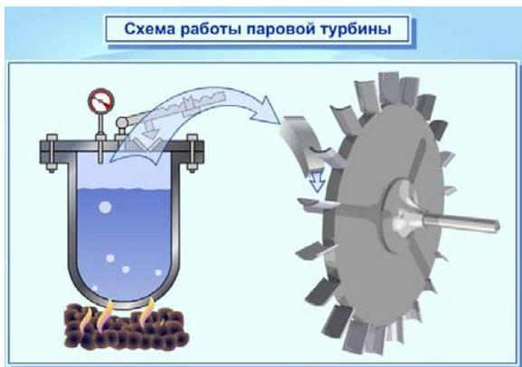
таких машин получают электричество на тепловых или атомных электростанциях. Сгорает уголь, нагревает воду, вода превращается в пар, пар под давлением ударяет по лопаткам турбины и приводит её во вращение. Таким образом, теплота превращается в механическую работу. Если рассматривать сущность работы тепловой машины, то различают три её части: *нагреватель*, *рабочее тело* и *холодильник*. В каждом цикле работы двигателя рабочее тело получает некоторое количество теплоты от
