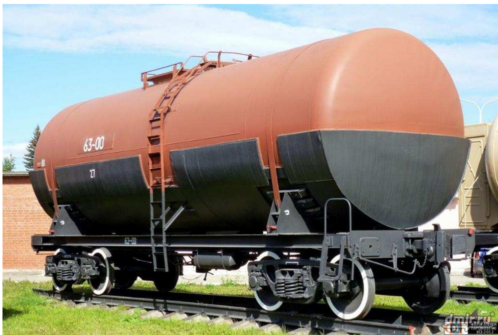
Рисунок 8 – Цистерна с подогревательным кожухом для перевозки вязких нефтепродуктов (например, битума)
