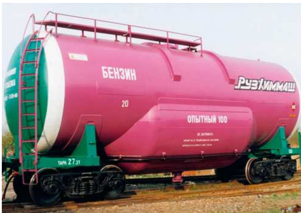
Рисунок 6 – Цистерна с переменным сечением котла
