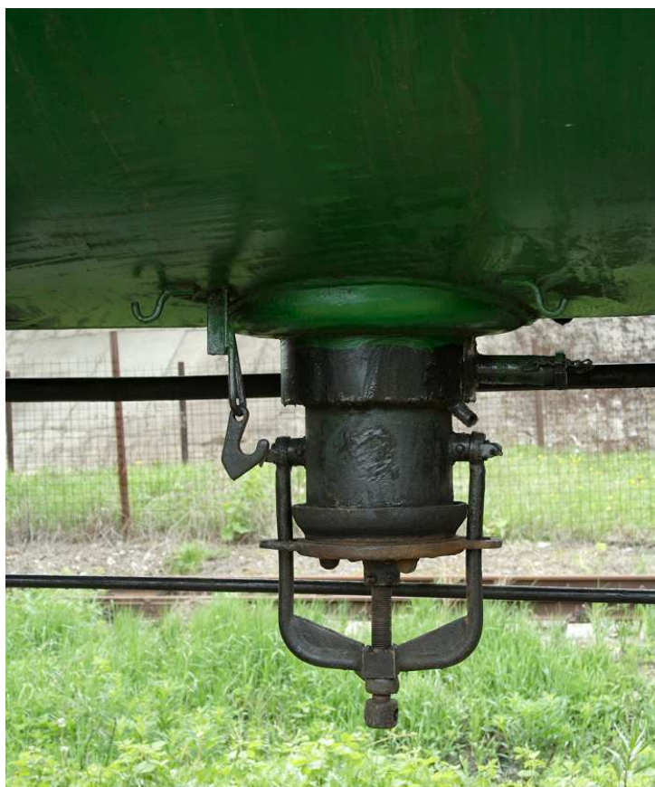
Рисунок 11 – Универсальный сливной прибор на вагоне
